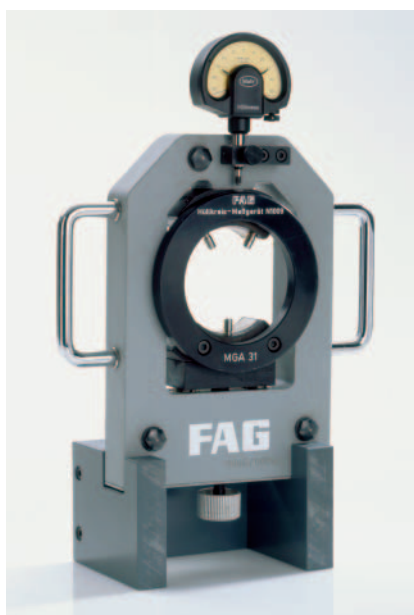
15: Instrumento de medición del círculo límite FAG MGA 31 para ajustar el juego radial de rodamientos de rodillos cilíndricos con anillo exterior desmontable.
