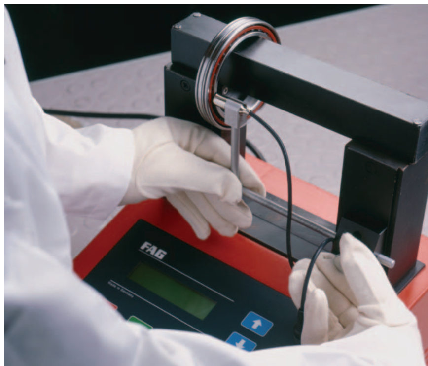
3: Calentamiento de un rodamiento para husillos mediante un dispositivo de calentamiento por inducción
